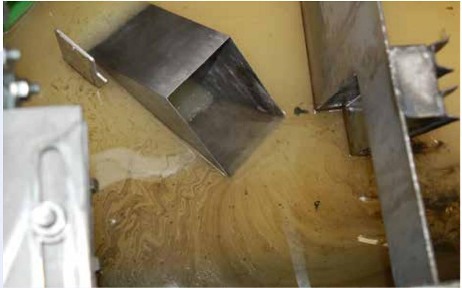
Ein Suparskim® Skimmer in Aktion, montiert im Tank eines Kunden. Öl wird automatisch und kontinuierlich mit der Strömung entfernt.
