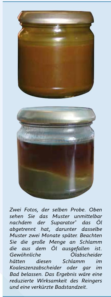
Zwei Fotos, der selben Probe. Oben sehen Sie das Muster unmittelbar nachdem der Suparator® das Öl abgetrennt hat, darunter dasselbe Muster zwei Monate später. Beachten Sie die große Menge an Schlamm die aus dem Öl ausgefallen ist. Gewöhnliche Ölabscheider hätten diesen Schlamm im Koaleszenzabscheider oder gar im Bad belassen. Das Ergebnis wäre eine reduzierte Wirksamkeit des Reingers und eine verkürzte Badstandzeit.
